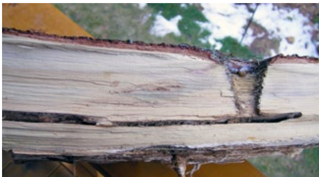
Tunnel creusé par des insectes se nourrissant du bois. © Sylvain Rioux
